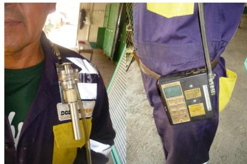
**Imagen 4: Instalación de Equipo de Monitoreo de Exposición al Polvo**
