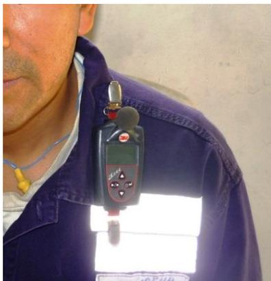
**Imagen 5: Instalación de Dosímetro de Exposición al Ruido**
