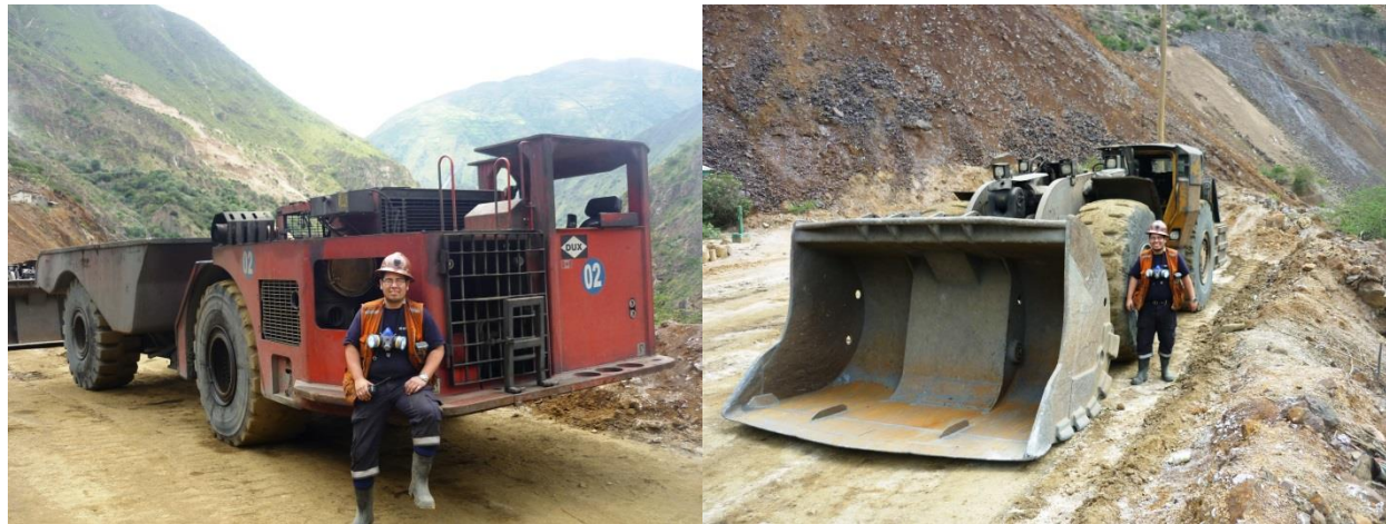
Ilustración 2: Equipos de Carguío y Acarreo de Mineral de Gran Dimensión. Dux 30 TN (Izquierda) y Scoop R2900 (Derecha).
