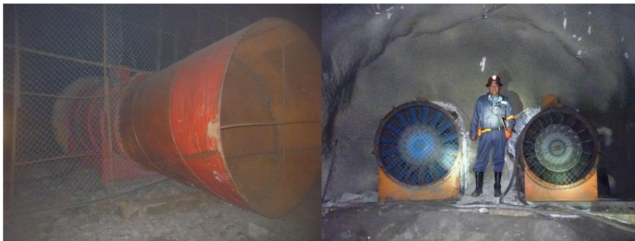
Ilustración 5: Ventiladores Secundarios, RB 1640 (Izquierda) y RB 2020 (Derecha). Ambos Inyectores de Aire Fresco.
