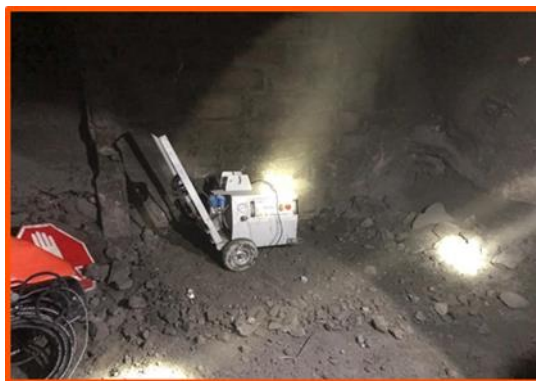
Ilustración 6: Implementación de Cañón nebulizador en contra flujo.
